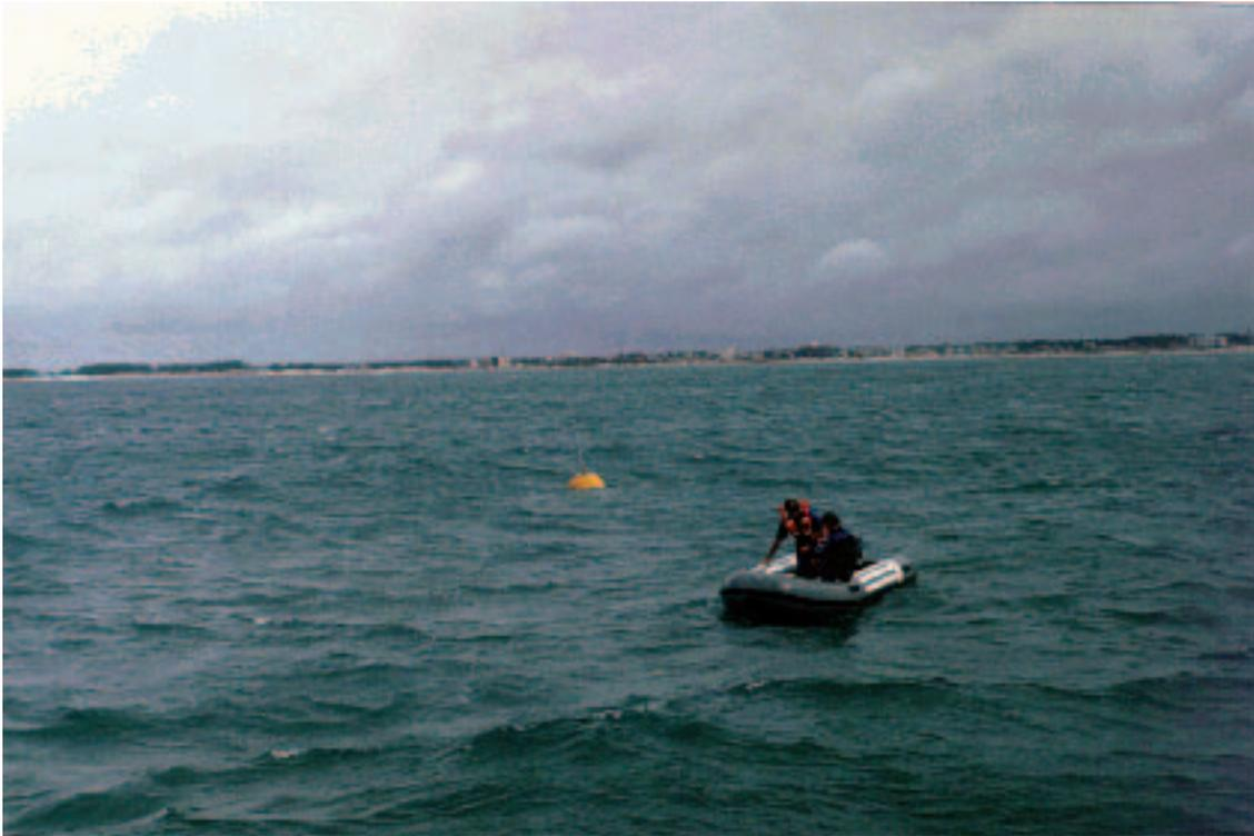
**Figura 2.** Fundeio do ondógrafo direcional Dataweel a 18 m de profundidade na Praia de Tramandaí (Fotografia Luiz Emílio S. B. Almeida, 1996).
