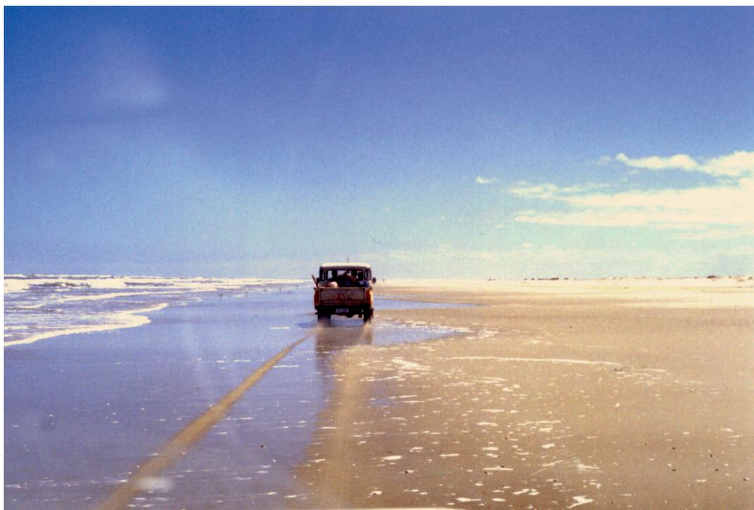
**Figura 5.** Levantamento da linha de praia com sistema de posicionamento global – GPS, fixado em um veículo que se desloca ao longo da linha de água associada ao espraiamento da onda (Fotografia Elírio Toldo Jr., 1998).
